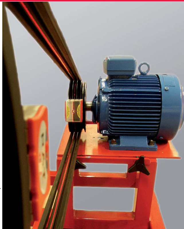
Les 2 traits laser facilitent la mesure et le réglage.
