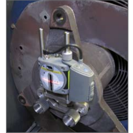
2. Montage pour mesurer sans couplage. Installé sur la bride du générateur. Adaptée à la plupart des turbines Vestas.
