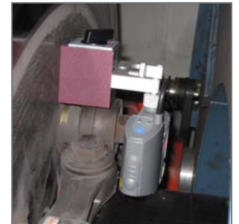
4. Montage sur disque de frein avec base magnétique. Adapté à la plupart des turbines Siemens.
